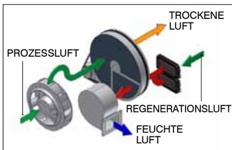
Regenerationssegment, wobei die Luft stark erhitzt wird und die heiße feuchte Luft dann per Schlauch nach draußen geführt wird.
